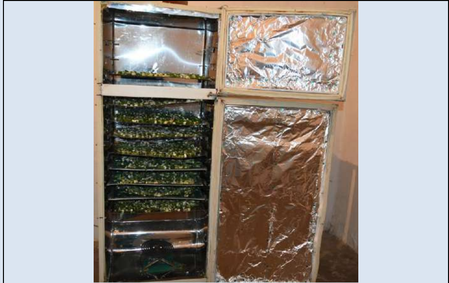
Foto 6: Adaptación de la nevera en deshidratadora.
